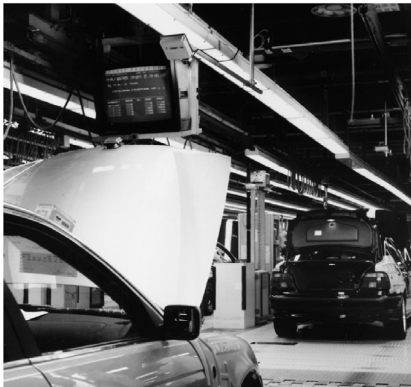
Abbildung 16: Industrielle Fertigung – aktiver RFID-Transponder an Motorhaube. Quelle: RFID-Handbuch, 2015, S.691
