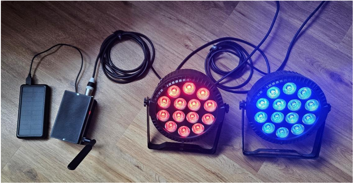
Abbildung 34: Ergebnis des Versuchs zur DMX512-Protokollkonformität: die zwei Scheinwerfer zeigen das erwartete Signal.
