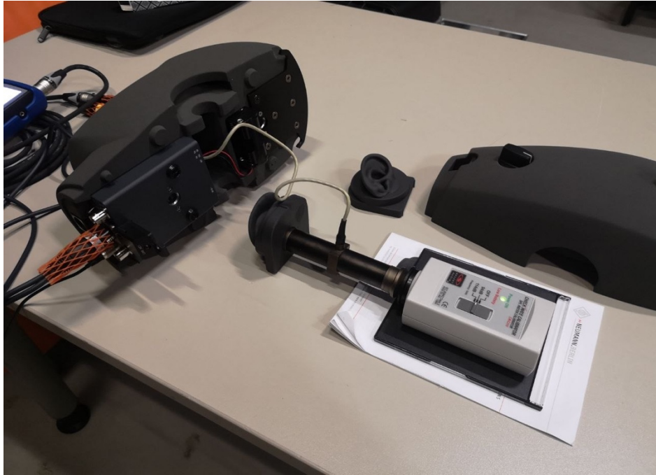
Abbildung 11 - Kalibrierung des Messsystems Quelle: Eigene Darstellung
