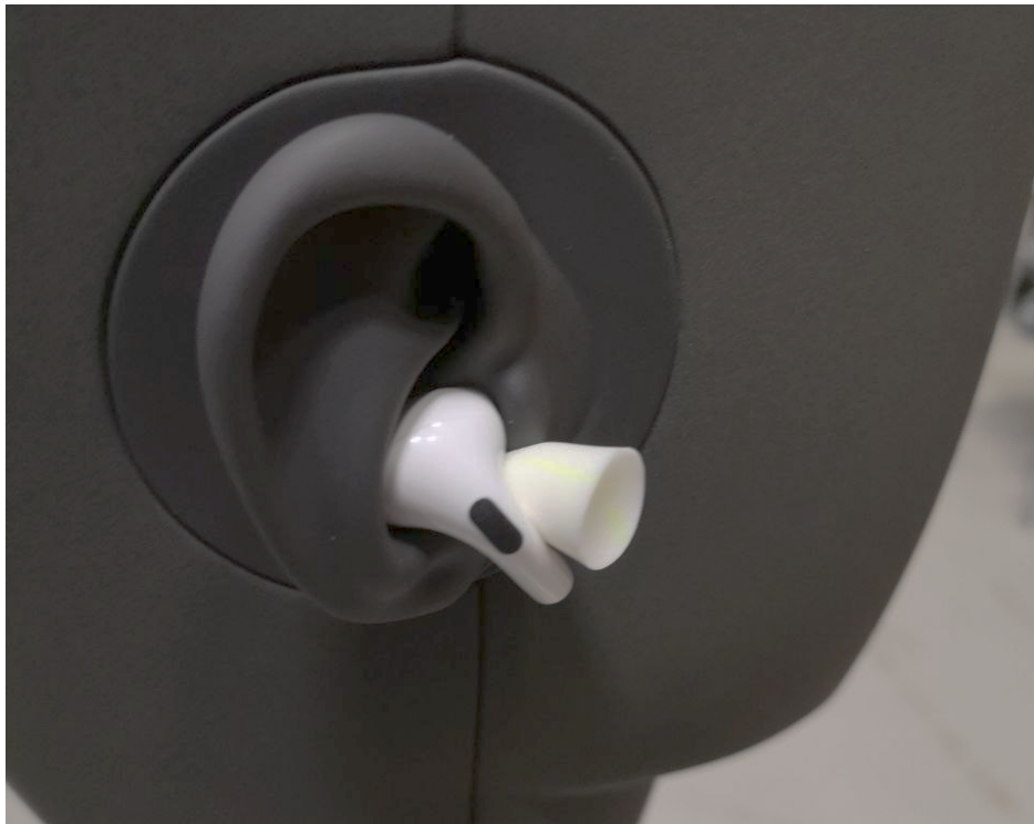
Abbildung 13 - KU100 mit Apple AirPod Pro und Ohropax Quelle: Eigene Darstellung
