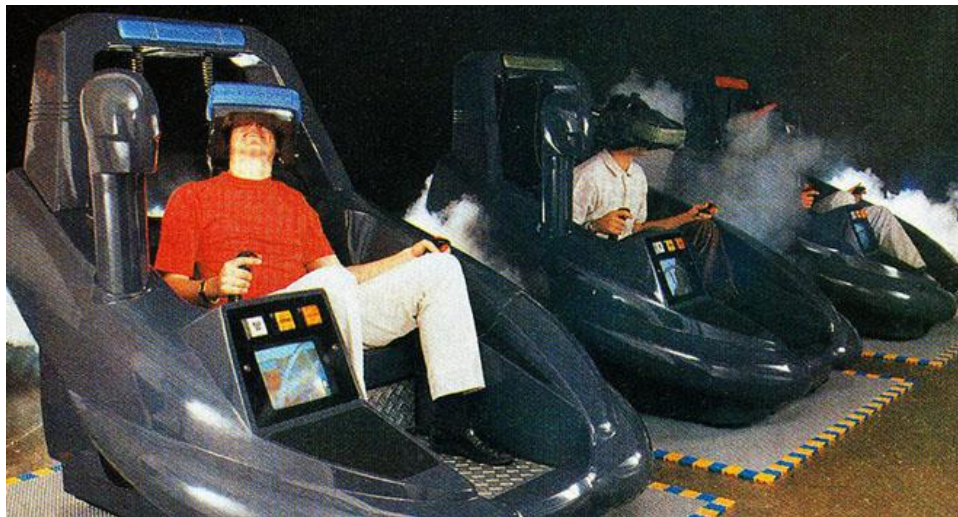
Abbildung 4: Die VR-Arcade-Pods Virtuality der Virtuality Group (1991), eines der ersten massenproduzierten VR-Unterhaltungssystemen mit Head-Mounted Displays und immersiven 3D-Darstellungen für sitzende Spielerinnen und Spieler. Quelle: t3n (2025).
