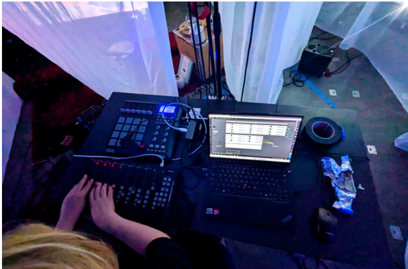
Abbildung 4.5: Try-Out Session im Tonlabor – Integrierung von Live-Diffusion durch Midi-Controller und der Verbindung zu Max/MSP als zentrales Steuerungsmodul
