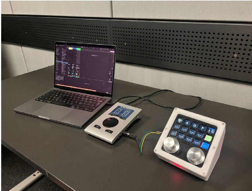
Abbildung 33: Messaufbau für den Potentiometer-Pfad.
