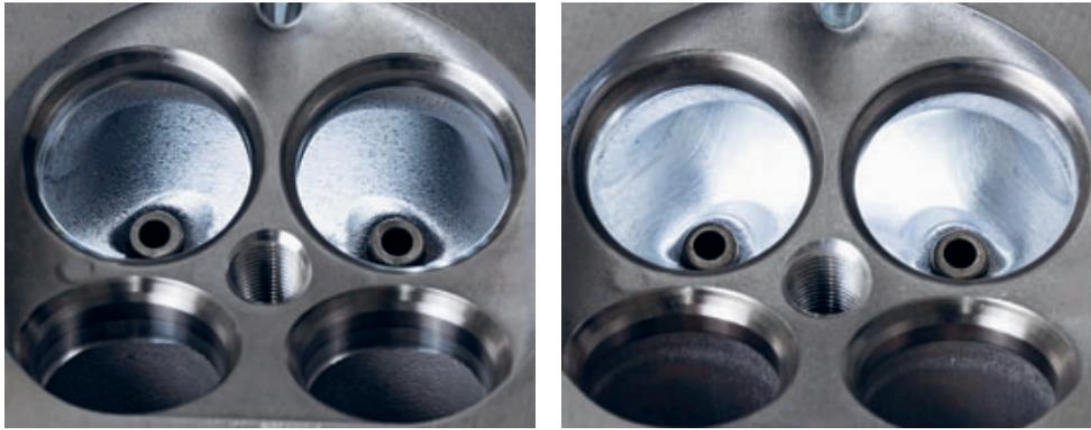
Abbildung 13: Unterschied der Zylinderköpfe [84, S.30]
