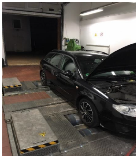
Abbildung 18: Seat Exeo auf dem Fahrzeugrollenprüfstand
