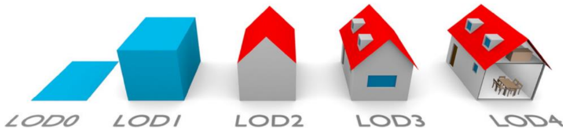
Abbildung 1: Beispielhafte Darstellung der 5 Detailgrade (LoDs) eines 3D-Gebäudemodells. Übernommen aus [7].
