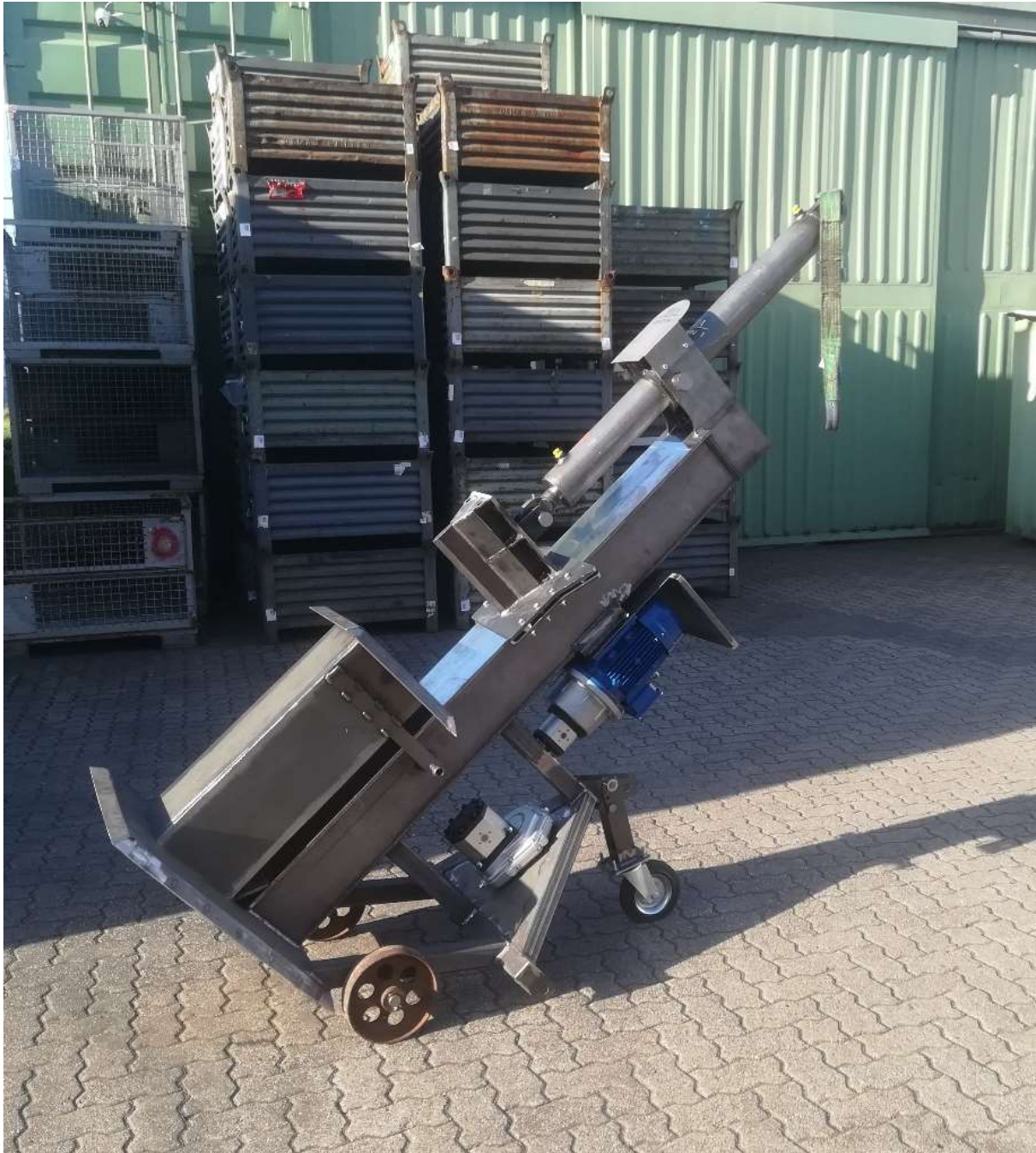
Abbildung 33: Holzspalter nach Beendigung aller Schweißarbeiten
