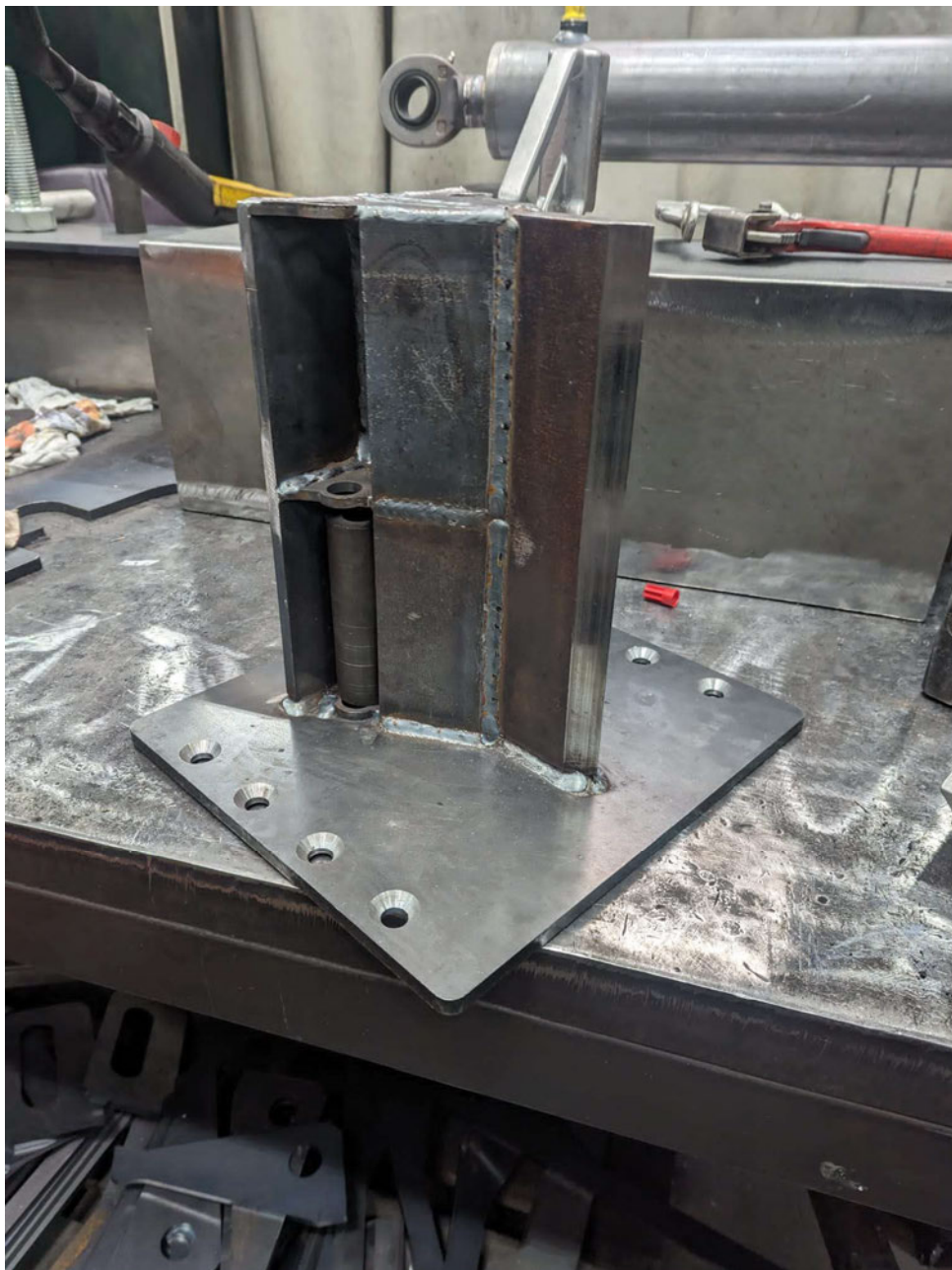
Abbildung 32: Fertig verschweißter Spaltkeil
