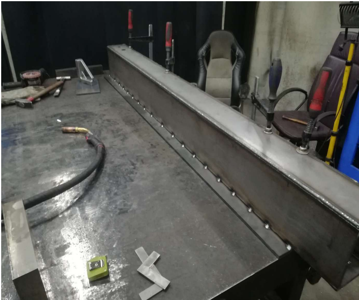
Abbildung 28: Verschweißen des Grundgerüsts
