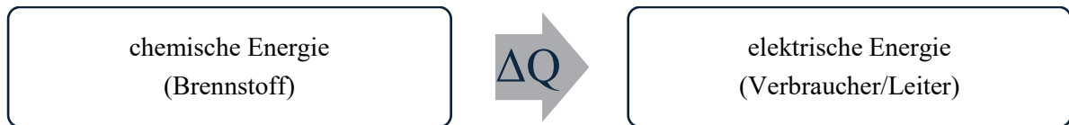
Abb. 1: Schematische Energieumwandlung in einer Brennstoffzelle. \Delta Q : Wärmeverluste (eigene Darstellung)
