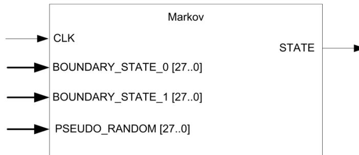
**Abbildung 6-27 IP-Symbol der Komponente Markov**
