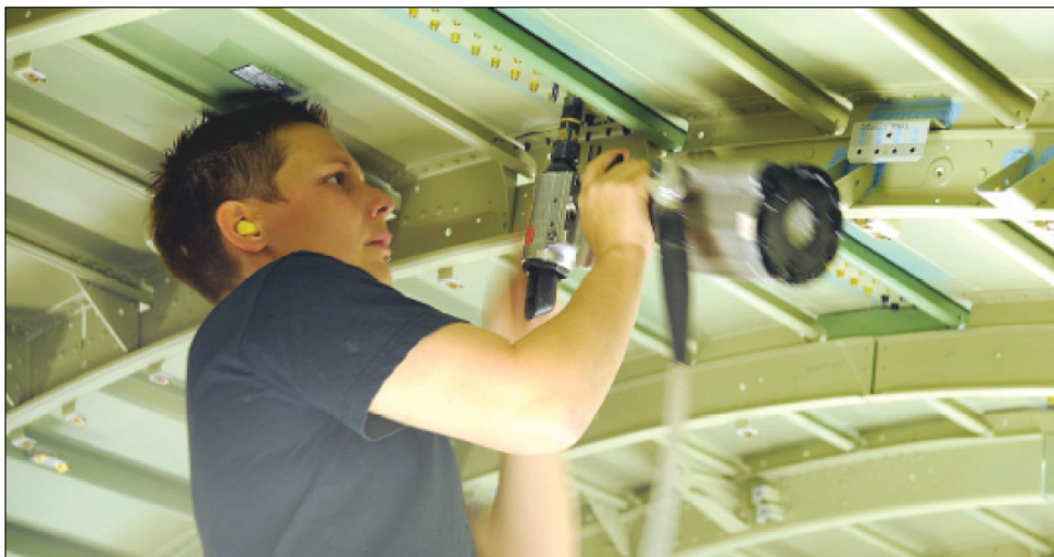
Abbildung 4: Lockboltsetzprozess in der Praxis [2b]
