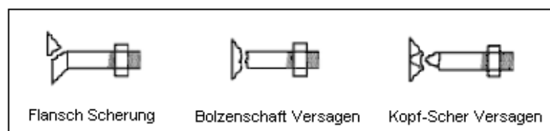
Abbildung 24: Übersicht über die Versagensmodi am Lockbolt nach Kopfzug
