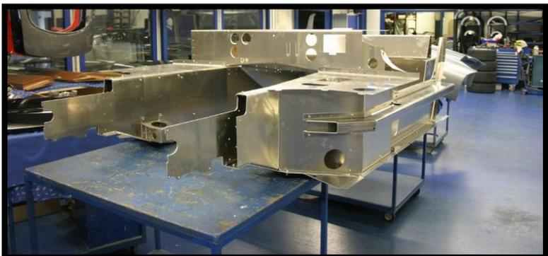
und bietet hohe Steifigkeit gegen Biegung und Torsion. Vor allem der übergroße Tunnel in der Mitte des **Abbildung 19: Wiesmann GT Rahmen**
