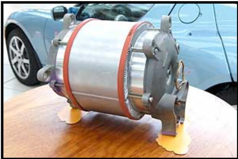
möglich bestehende Fahr- **Abbildung 13: Elektromotor Tesla Roadster** zeuge schnell auf einen Elektroantrieb umzurüsten. Der für den Einsatz im Fahrzeug verwendete Motor würde ungefähr die Maße eines Fußballs erreichen und ca. 15kg – 25kg wiegen (vergl. Abbildung 13).
