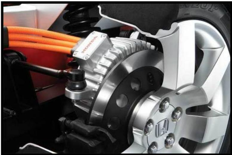
Abbildung 14: Radnabenmotor
