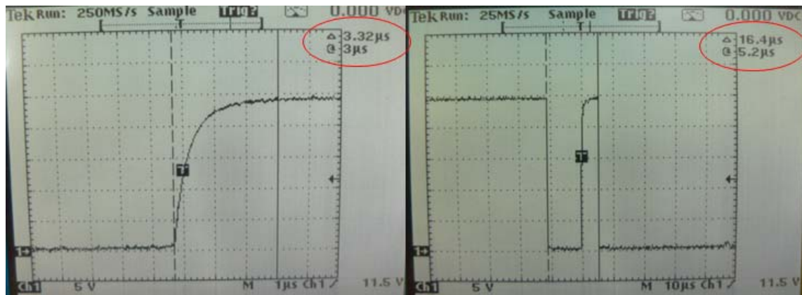
Abbildung 3-8: Transiente Reedschalter-Vorgänge beim Umschalten
