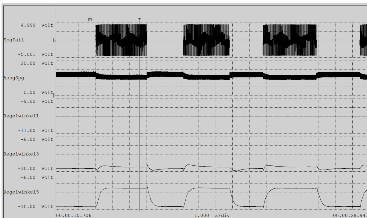
Abbildung 9.7: Ausregelung eines Spannungsfalls in einem Außenleiter
