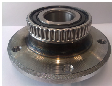
Abbildung 2.4.: Radlager mit passivem Encoderrad eines BMW 330i Touring
