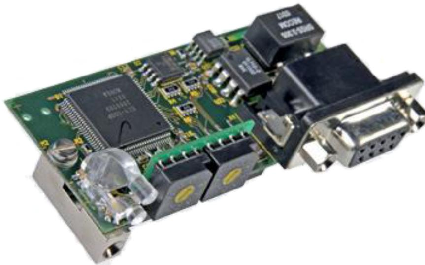
Abbildung 20: Hilscher COM-CA-DPS Modul
