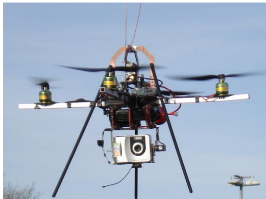
Abbildung 2.3.: Quadcopter mit Digitalkamera [FH Bielefeld (2010)]
