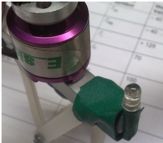
Abbildung 6.3.: 1. LED-Version mit 30° Abstrahlwinkel
