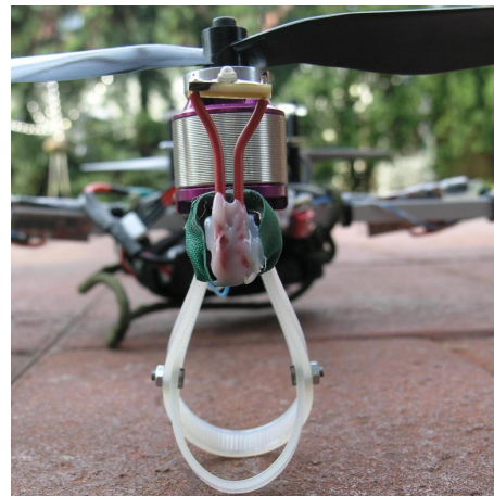
Abbildung 6.4.: 2. LED-Version mit 60° Abstrahlwinkel
