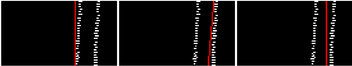
Abb. 62: Darstellung des Ergebnisses der Hough-Transformation für Pixel, die in der Region of Interest (Abbildung 61) liegen; Intervalle: 1 Bit (links), 2 Bit (mitte), 3 Bit (rechts) (vgl. Kap. 7.2.3)
