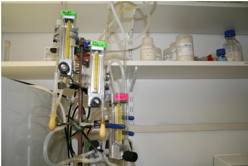
**Abb. 3.1. Rotameter mit den dazugehörigen Durchflussmesssäulen, die für die Bestimmung und Einstellung der Begasungsraten eingesetzt wurden**
