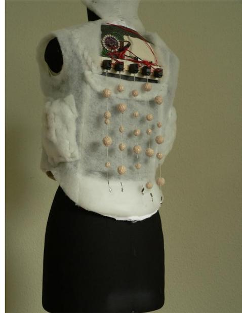
(b) Drehbare Servomotoren mit daran befestigten Kugeln
