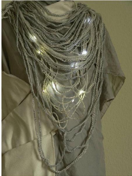
Abbildung 2.23.: Herzschlag wird über XBee an LEDs übertragen
