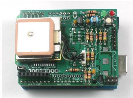
Abbildung 3.5.: GPS Shield und Data Logger [43]
