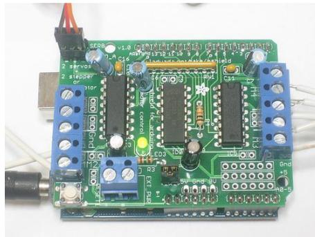
Abbildung 3.2.: Motor Shield für den Arduino Duemilanove [44]
