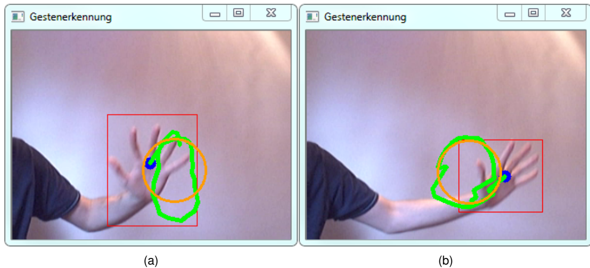
Abbildung 4.9: Die Hand führt eine Kreisbewegung aus und dies wird als Geste erkannt
