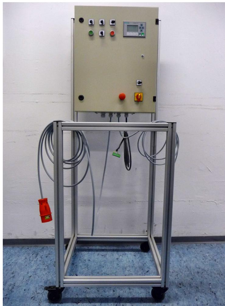
Abbildung 5.1: Neu entwickelter Motorenprüfstand
