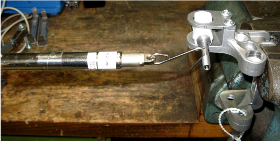
Abbildung 13: Messaufbau Drehpunkt Spindelmutter HV
