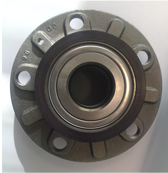
Bild 1.1: Aktives Encoderrad des VW Golf V, an der Stirnseite magnetisiert [9]
