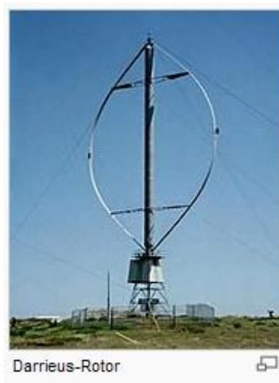
Abb 001: Darrieus Rotor, Quelle: [www.wind-energie.de](http://www.wind-energie.de)
