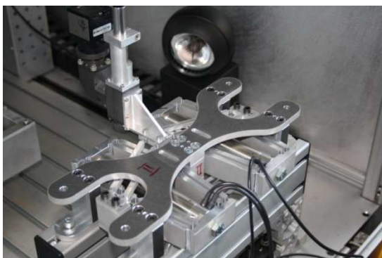
Abbildung 4.6: Mikrobearbeitungseinheit mit Laseroptik und Werkstückträger
