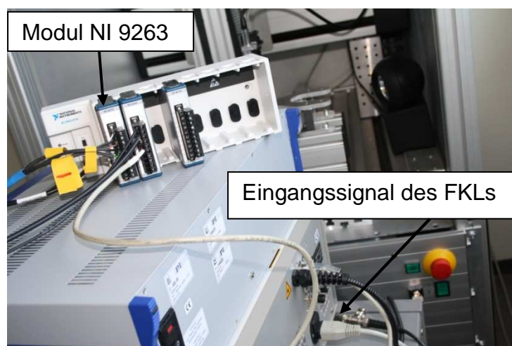
Abbildung 4.4: Verkabelung zwischen NI Modul 9263 und Festkörperlaser
