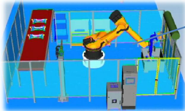
Hier ist eine Roboterzelle mit der vorhandenen Schutztür zusehen. Der Roboter nimmt Teile von der Verkettung und legt diese in den Behälter, am rechten Bildrand, ab. Diese Zelle wurde, unter dem Einsatz von Process Simulate, einer Analyse unterzogen. In diesem Layout muss der MA einmal quer durch den Sicherheitsbereich gehen um an die betreffende Stelle zu kommen. Der Bereich, der von dem MA durchquert werden muss, stellt auch gleichzeitig den Bewegungsbereich des Roboters dar.
