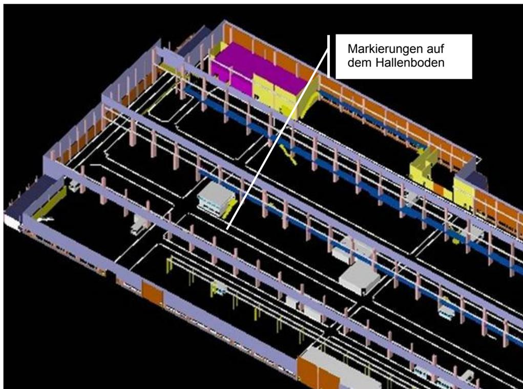
Abbildung 10: Abbildung von Verkehrswegen in den Produktionshallen<sup>88</sup>
