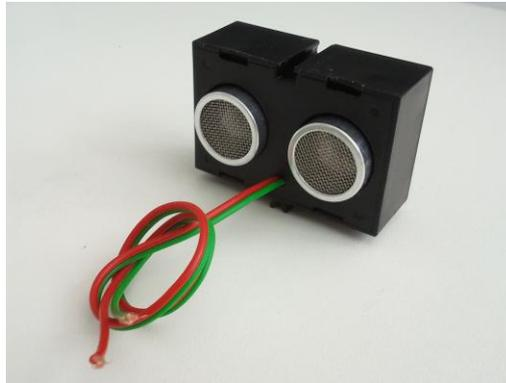
Abbildung 5.2 Ultraschallsensor von Fischertechnik
