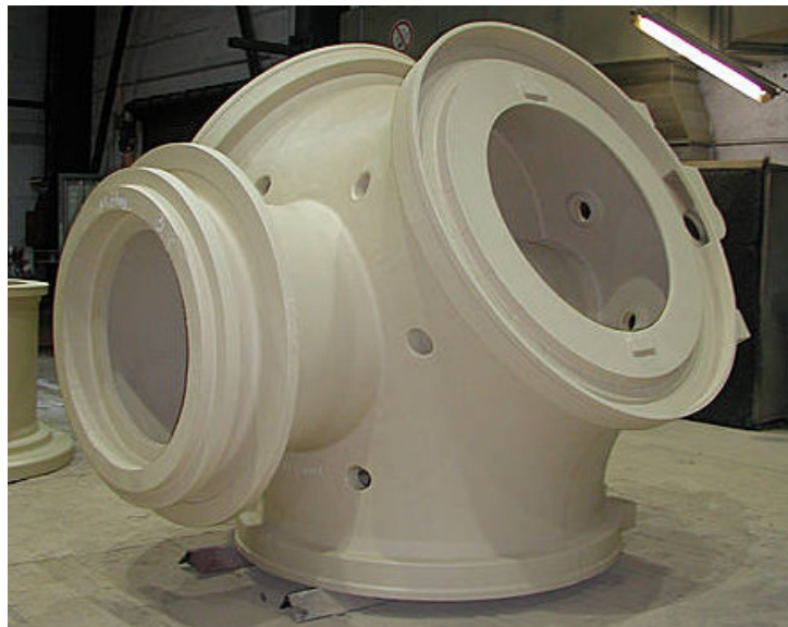
Abb. 2.7: Rotornabe hergestellt von der Meuselwitz Guss Eisengießerei GmbH [17]
