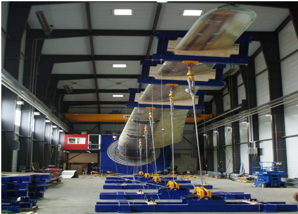
Abb. 3.4: Rotorblattprüfstand beim Fraunhofer IWES in Bremerhaven [12]
