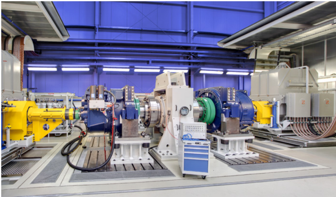
Abb. 3.7: Prüfstand für Getriebe von Windenergieanlagen der Firma ZF [28]
