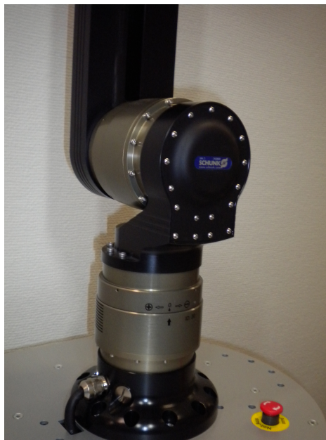
Abbildung 2.1: Die Gelenkarten des SCHUNK-Arms
