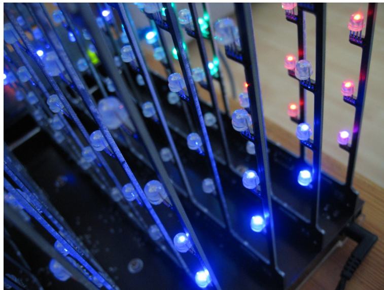
Abbildung 4.26: Schattenbildung durch Timing-Fehler
