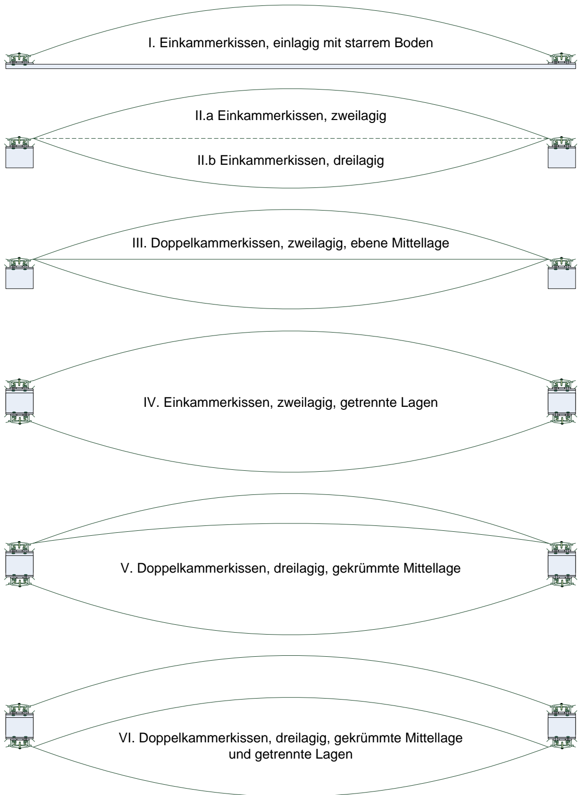
Abb. 18: Konstruktionsvarianten pneumatischer Folienkissen
