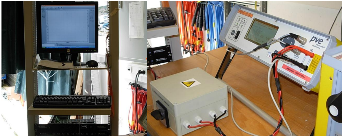
Abb. 54: Prüfstand >> Messung und Auswertung Rechner und I-U-Kennlinienmessgerät pve 1000C40 mit Lasttrennschalter
