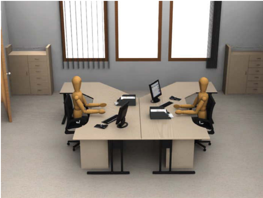
Abbildung 57: Büro mit optimaler Anordnung der Arbeitsmittel zur Vermeidung von Blendungen
