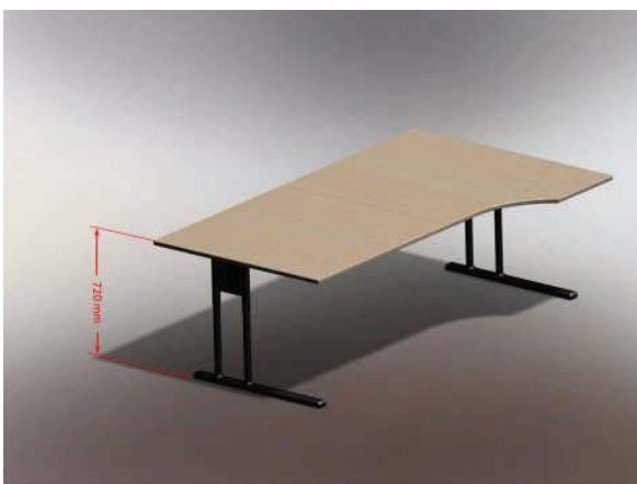
Abbildung 71: Höhe von Arbeitstischen nach DIN 4549
