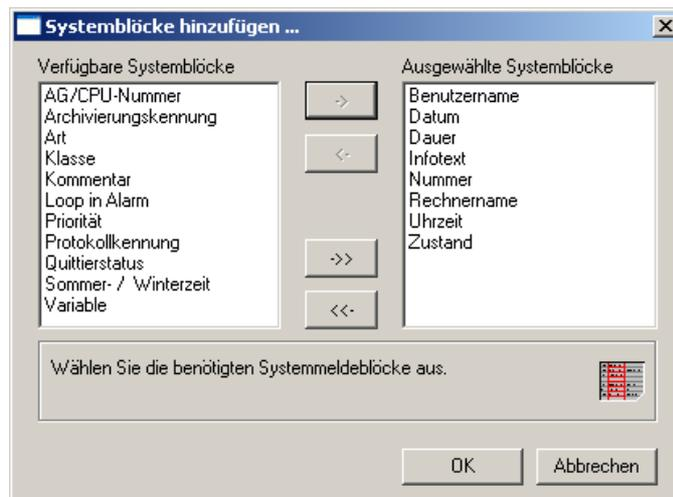
Abbildung 3.2 WinCC-Editor zum Bearbeiten der Systemblöcke
