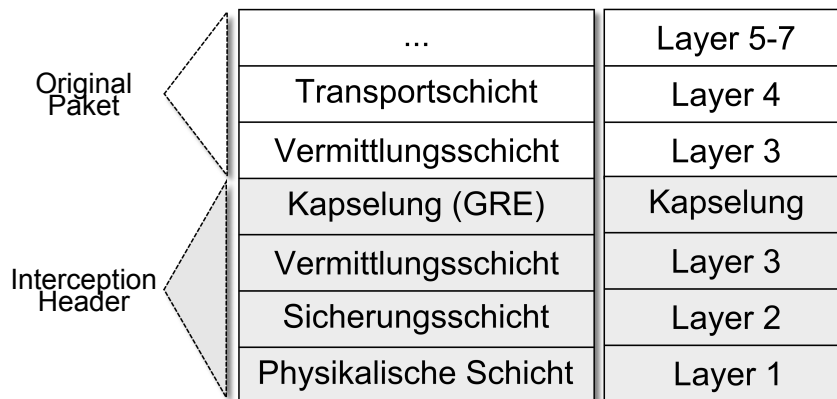
Abbildung 4.4: Layer 3 Umleitung - IP-in-IP Kapselung
