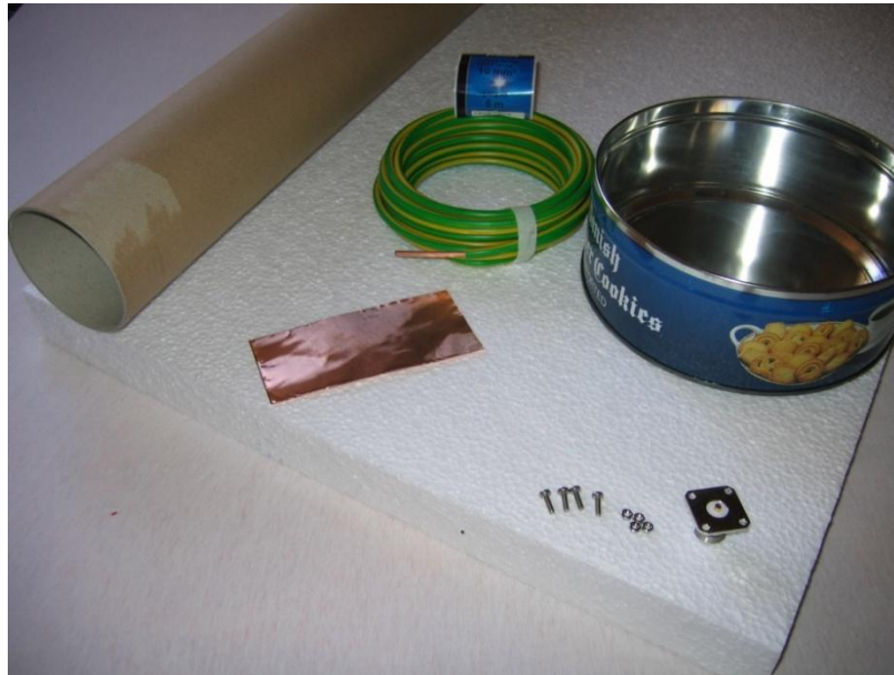
Abbildung 4-9 Materialien zum Bau der Helix-Antenne.
