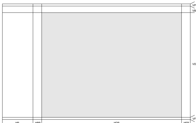
Abbildung 5.30.: Aufteilung des VGA-Signals in die einzelnen Zeitabschnitte. Nur der graue Bereich enthält das auf dem Monitor dargestellte Bild. VP = vertical pulse, VBP = vertical back porch, VFP = vertical front porch, VDP = vertical display period, HP = horizontal puls, HBP = horizontal back porch, HFP = horizontal front porch, HDP = horizontal display period
