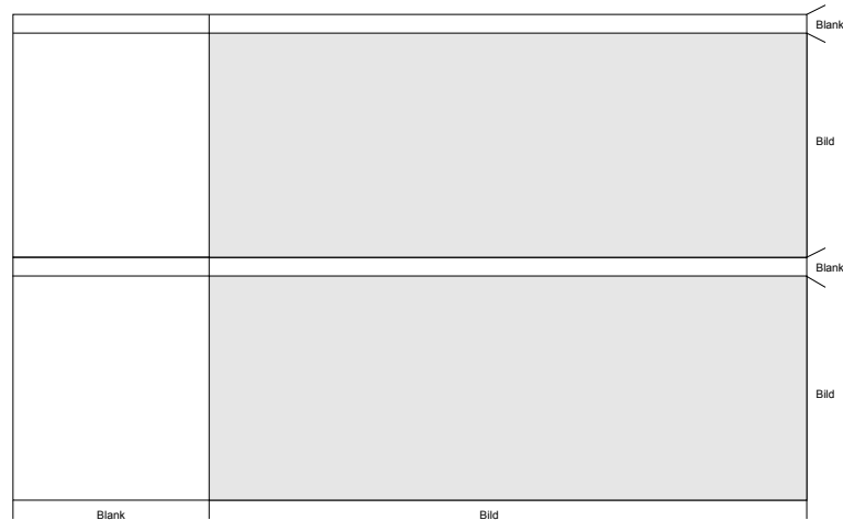
Abbildung 5.4.: Bildaufbau eines Kamerabildes im 480i-Datenstrom. Die Halbbilder und die Bildeilen sind durch Blankabschnitte voneinander getrennt. (Jack, 2005, Abb. 4.8, Seite 42)
