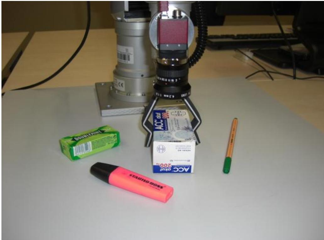
Abbildung 14.9: Katana-Greifarm nach dem Greifen der Schachtel
