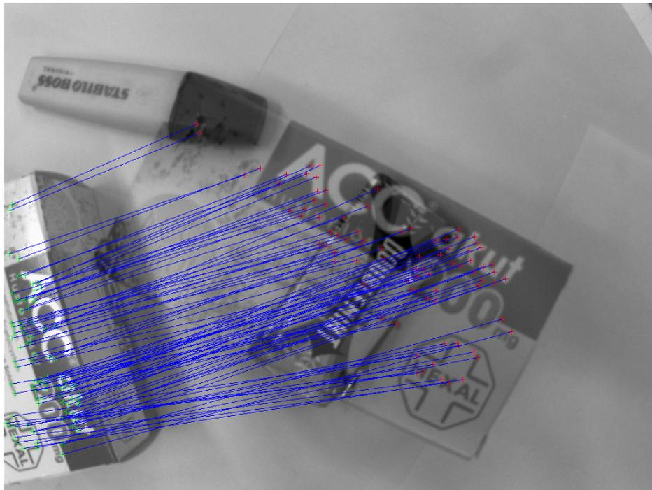
Abbildung 14.2: Punktpaare bezüglich der überlagerten Ansichten  $B^*$  und  $B$  nach der Wiedererkennung
