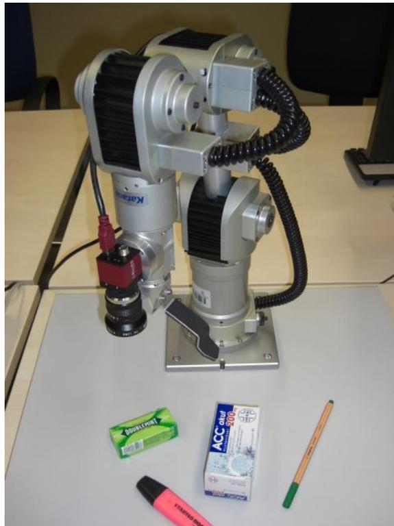
Abbildung 14.1: Katana-Greifarm nach der Identifikation der Schachtel im aktuellen Kamerabild
