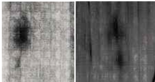
Abbildung 88: Thermografie-Aufnahmen von Delaminationen nach dem Impact
