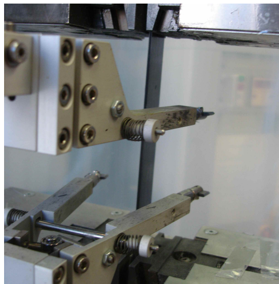
Abbildung 69: Eingespannte Zugprobe mit Multisens-Wegaufnehmern für statische Prüfung
