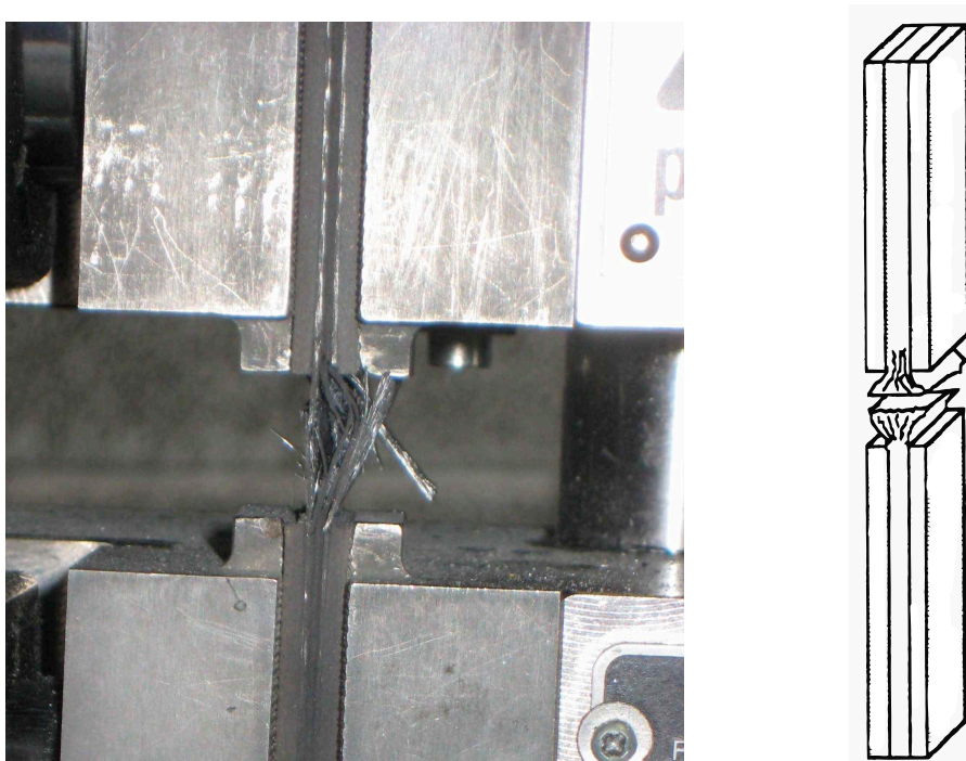
Abbildung 72: Links: Bild der zerstörten Proben, rechts: schematische Zeichnung des BGM-Versagens 124
