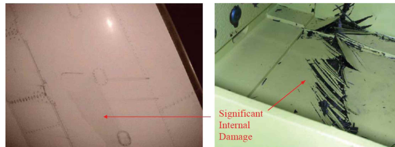
Abbildung 20: Diskrepanz zwischen äußerer Wahrnehmung und realem Schadensbild 31
