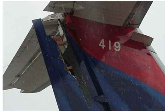
Abbildung 26: Schwere Leitwerksbeschädigung durch Blitzeinschlag 40
