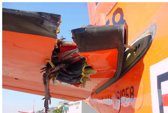
Abbildung 27: Vogelschlag an einem Höhenleitwerk 41
