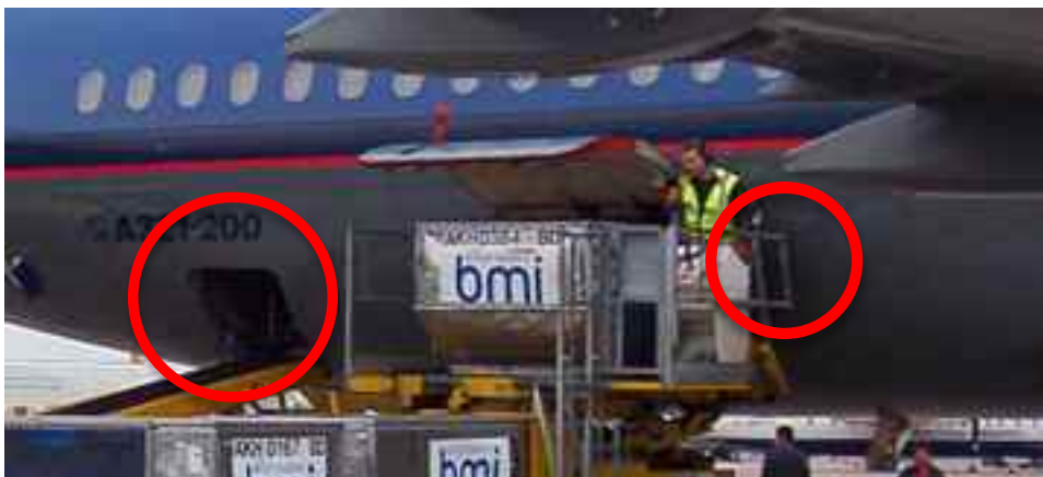
Abbildung 4: Frachtbeladung einer A321, links: Bulk Cargo Beladung mit Förderband, rechts: Standardcontainer auf Cargo Loader mit seitlichen Stützgeräten 4
