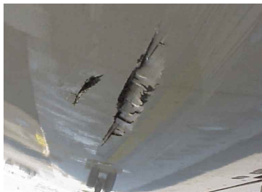
Abbildung 25: Beschädigung der Kategorie 3 an einem Flugzeugrumpf 39
