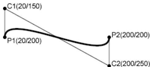
Abbildung 3.1: Die Kurve wird von <path>-element aus Listing 3.1 dargestellt
