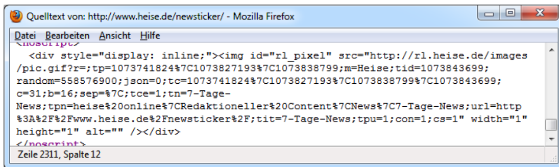
Abbildung 3.1: Typischer Zählpixel im HTML-Quellcode von heise online
