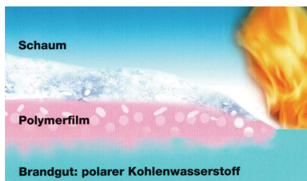
Abb. 16: Schematische Darstellung des Polymerfilms auf einem unpolaren flüssigen Brennstoff [25]
