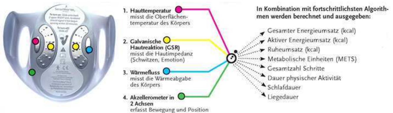
Abb. 9 – Sensoren und Messparameter des SWA
