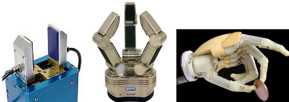
Abbildung 1.2.: Beispiele für Greifer: Zwei-Finger-Greifer Schnuk PG70 [24], Dreifingergreifhand Schunk Dextrous Hand SDH-2 [23] und i-Limb ProDigits von Touch Bionics [23] (v.l.n.r)
