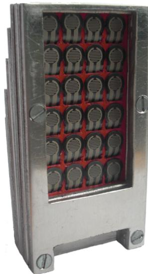
Abbildung 5.5.: Eingebaute Sensorplatte mit aufgeklebten Sensoren
