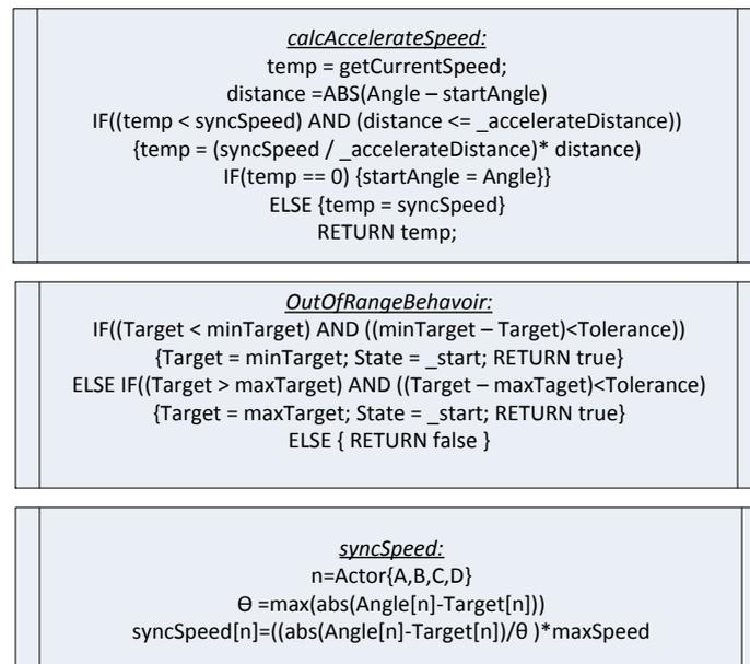
Abbildung 5-30 Hilfsfunktionen RotateCtrl
