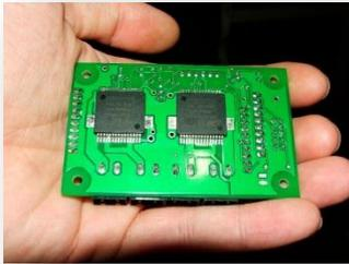
Abbildung 4-4 Motorsteuerung
