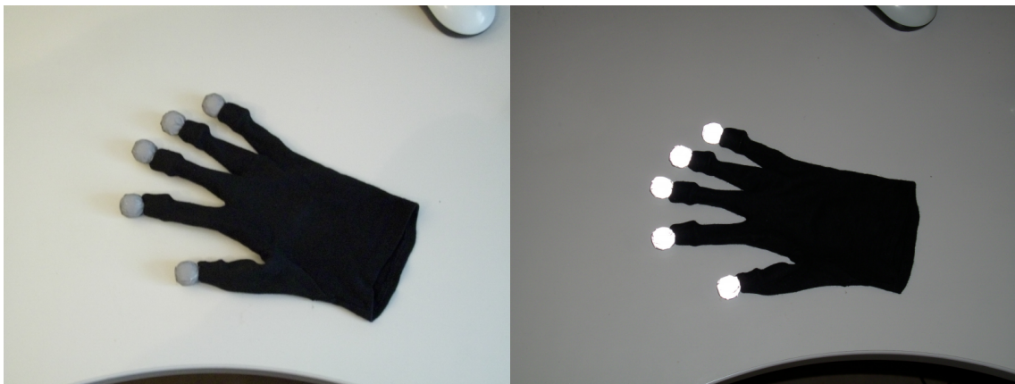
Abbildung 4.1: Selbstgebaute Handschuh mit Markern links bei normalem Lichteinfall, rechts mit Blitz fotografiert
