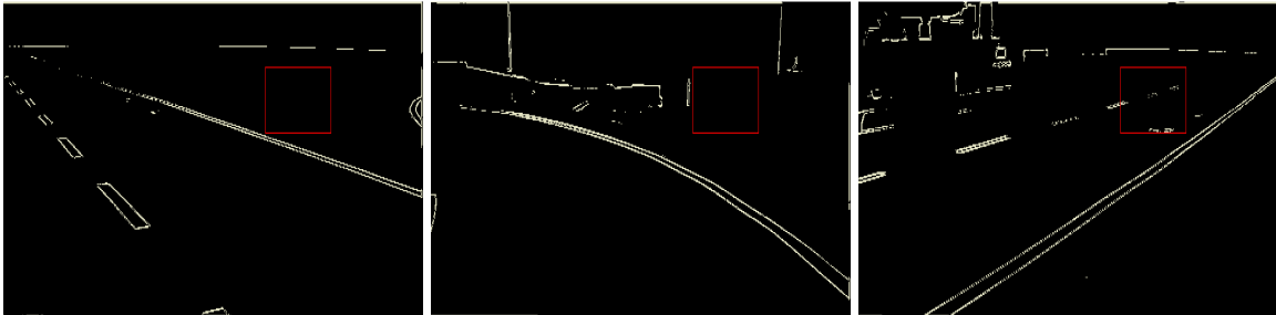
Abbildung 47: Folgen der festen Positionierung der ROI im perspektivisch verzerrten Sobel-Bild. Aufgrund der Fahrzeugbewegung in Kombination mit der Kameraperspektive treten Situationen auf, in denen keine gültigen Ergebnisse der Spurerkennung ausgewertet werden können.
