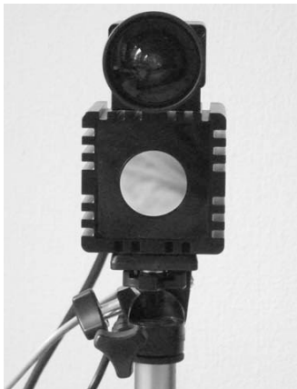
(a) RGB und ToF Kamera Kombination. Quelle: Van den Bergh u. Van Gool (2011)
