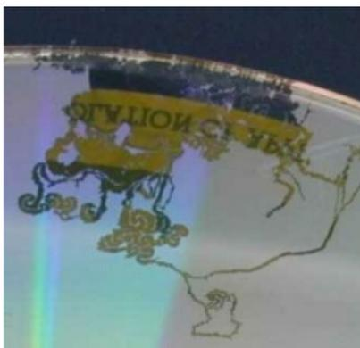
Abb. 4: Von Pilzfraß befallene CD (vgl. [www.heise.de](http://www.heise.de). 23.05.2006)
